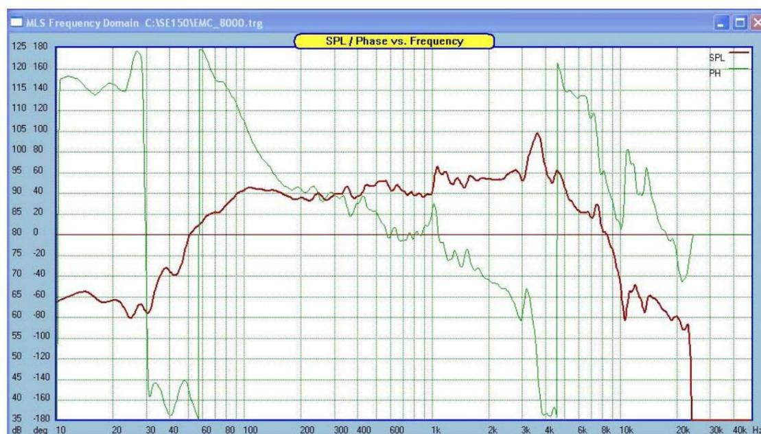
Un'onda quadra a 300Hz riprodotta da questo altoparlante è fortemente distorta. Il forte squillo è dovuto a un picco SPL acuto di 10 dB situato a 3,5 kHz. Puoi vedere che ci sono circa 11 periodi di forma d'onda squillante in un periodo di onda quadra a 300Hz.
